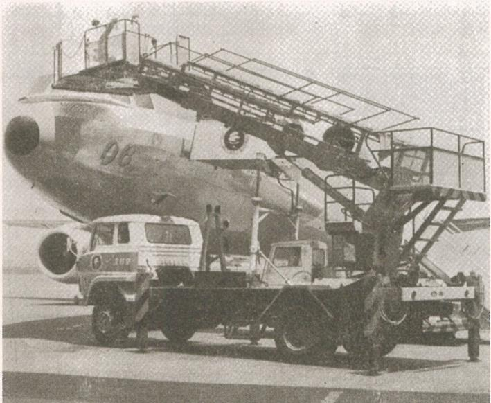
空港で作業中のビームリフタ。『風雪と激動の40年 油圧に生き 油圧を超えて』(1975年 葦場工業株式会社刊) より
